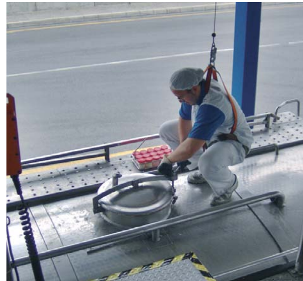
El trabajo en altura requiere siempre el empleo de los EPI's adecuados
